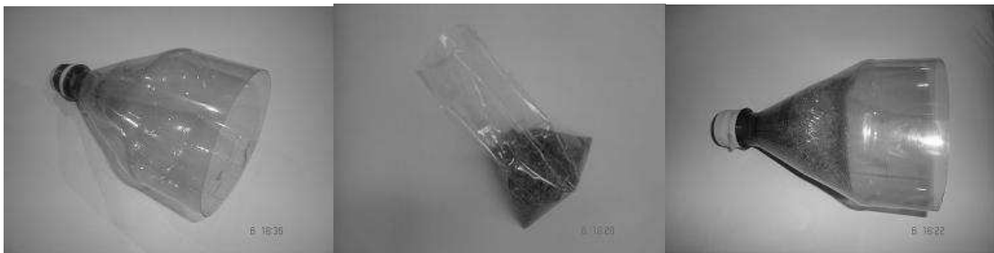
Figura 1. Peças e montagem do bico do foguete.
